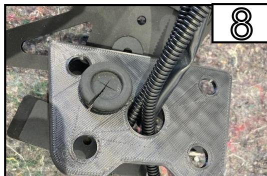
Führen Sie den Gummi auf die Kabel und befestigen Sie den Gummi im Ausschnitt.
