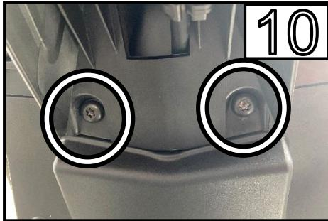
Entfernen Sie die beiden Schrauben.
