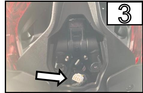
Trennen Sie den Hauptstecker des Kennzeichenträgers und entfernen Sie diesen vollständig. /
