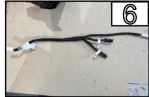
Entfernen Sie den Kabelbaum vollständig vom originalen Kennzeichenträger und verbinden Sie es mit den Blinkern und der neun Kennzeichenbeleuchtung. /
