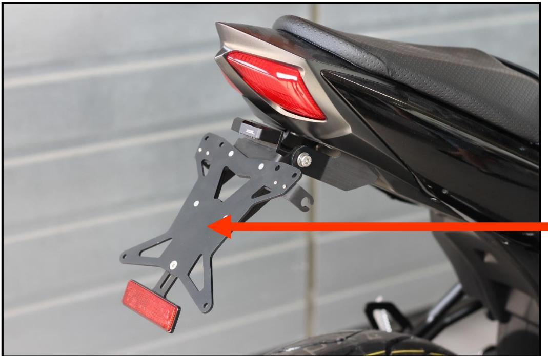
**DE: ACHTUNG:** Montieren Sie nur Ihr Nummernschild – verwenden Sie keine zusätzliche Stahl- oder Aluminium-Trägerplatte – dies kann zu Bruchschäden an der Halterung führen!!
