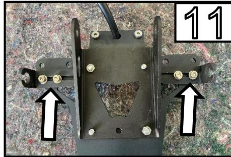
Montieren Sie die Blinkeraufnahmen mit dem M4 Schraubenset. /
