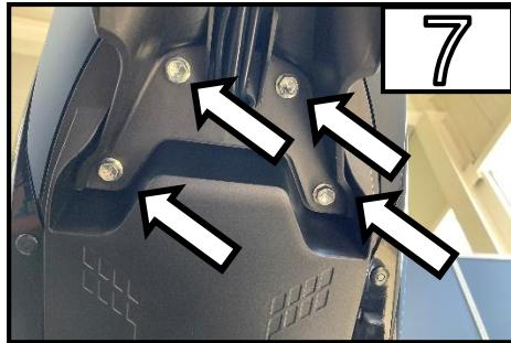
Entfernen Sie den originalen Kennzeichenträger indem Sie die 4 im Bild gezeigten Schrauben lösen. /
