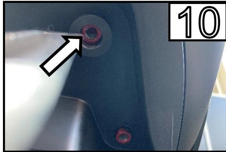
Achten Sie bei der Montage, dass die Distanzhülse sauber an der Verkleidung anliegt. /
