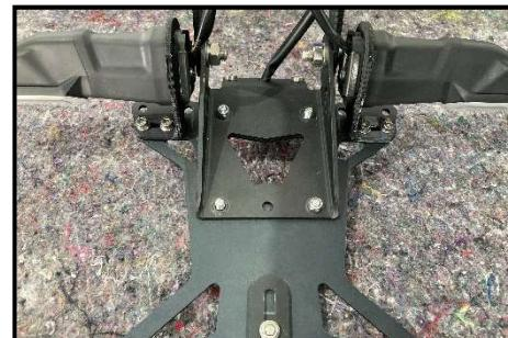
Montieren Sie die Blinkerhalter am Kennzeichenträger. /
