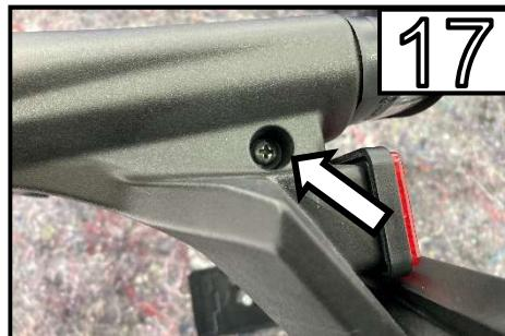
Entfernen Sie die Schraube neben der Kennzeichenbeleuchtung und teilen Sie die beiden Hälften des Kennzeichenhalters /
