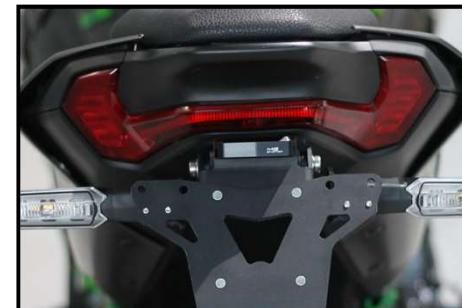
Verbinden Sie den Adapter mit der Kennzeichenplatte mit der mitgelieferten M8 Set.
