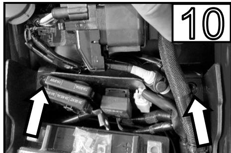
Entfernen Sie die beiden Schrauben neben der Batterie /
