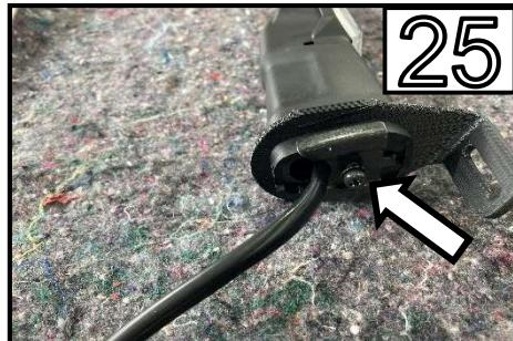
Befestigen Sie das Sicherungsblech wieder am Blinker. /
