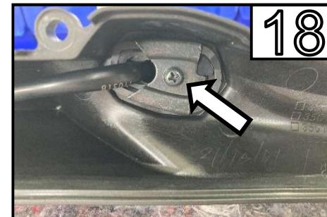
Öffnen Sie die Schraube und entfernen Sie den Sicherheitsbügel /
