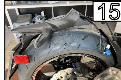
Ziehen Sie die 3 Kabel raus und entfernen Sie anschließend den Kennzeichenträger vom Motorrad /
