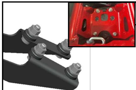
Sichern Sie die Schrauben lose am Heckrahmen mit den beigefügten M8 Scheiben und Muttern. /
