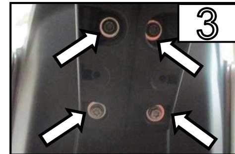
Entfernen Sie die 4 Torx Schrauben /
