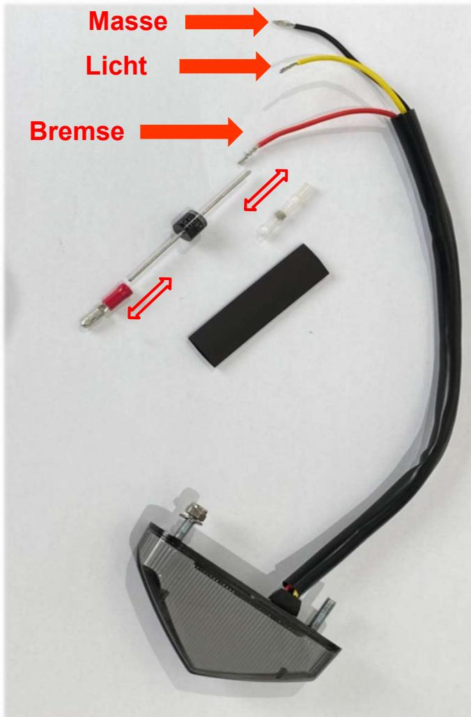
Zum Anschluss der Kennzeichenbeleuchtung mit Tempomat verwenden Sie beiliegenden Quetschverbinder, Diode, Lötverbinder und den Schrumpfschlauch.
