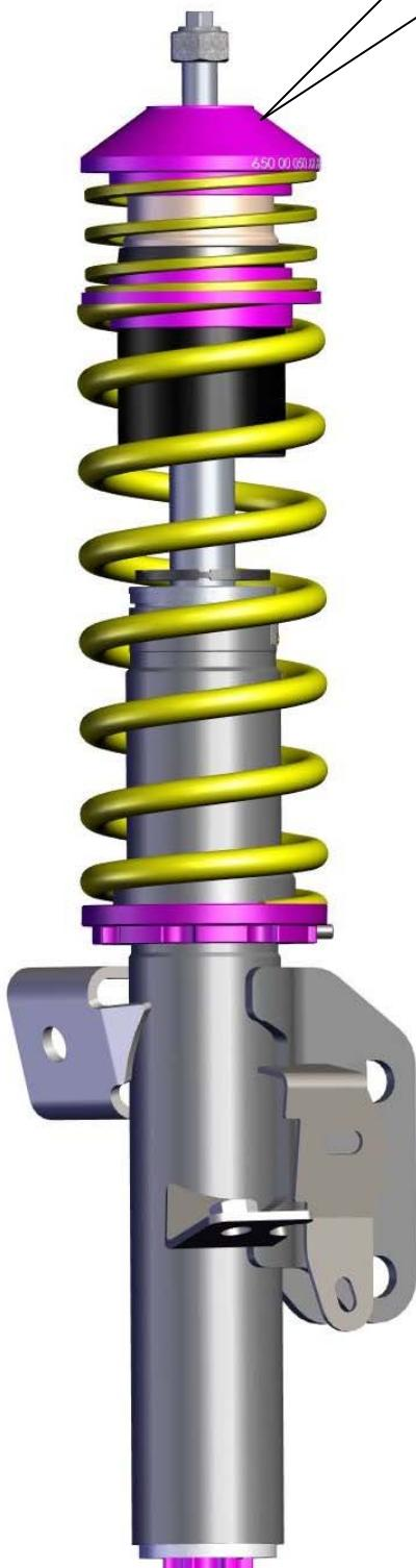
Original Stützlager ohne Gummiunterlage aufstecken und mit der mitgelieferten Stoppmutter verschrauben. Das Anzugsdrehmoment der Kolbenstangenbefestigung beträgt 35 Nm. Die Montagehinweise zum Einbau des Federbeines in das Fahrzeug, sowie die Anzugsdrehmomente der Federbeinbefestigung, entnehmen Sie bitte den Unterlagen des Fahrzeugherrstellers.
