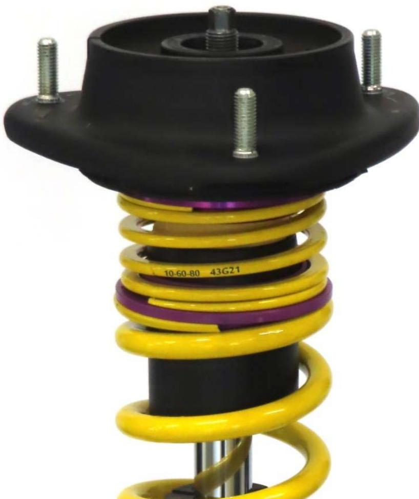
Nach erfolgtem Einbau des Fahrwerkes ist die Freigängigkeit der Bereifung zum VA-Federbein zu überprüfen. Das Mindestabstandsmaß darf an der engsten Stelle **5 mm** nicht unterschreiten und ist gegebenenfalls mittels handelsüblicher, geprüfter Distanzscheiben wieder herzustellen.
