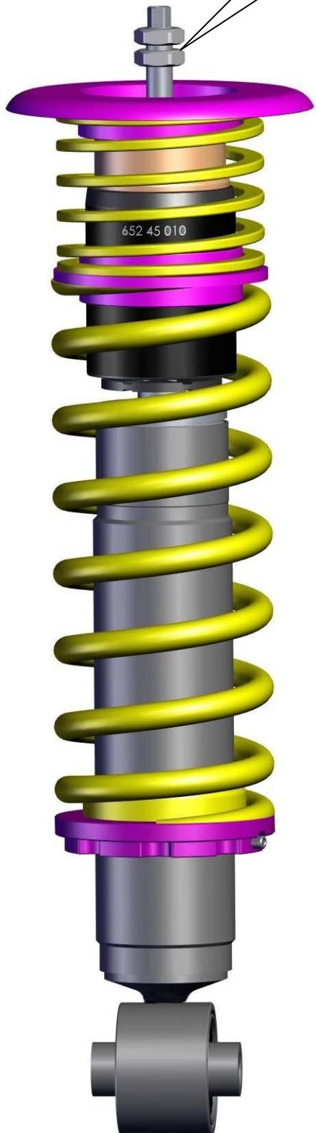
Original Stützlager aufstecken und mit den mitgelieferten Muttern verschrauben. Das Anzugsdrehmoment der Kolbenstangenbefestigung beträgt 20 Nm. Die Montagehinweise zum Einbau des Federbeines in das Fahrzeug, sowie die Anzugsdrehmomente der Federbeinbefestigung, entnehmen Sie bitte den Unterlagen des Fahrzeugherstellers.
