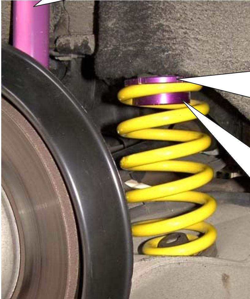
Die Höhenverstellung mit Scheibe wird oben eingesetzt, die serienmäßige obere Federunterlage wird nicht mehr verwendet. Zwischen Höhenverstellung und Karosserie wird die mitgelieferte Kunststoffscheibe montiert. Zum Korrigieren der Fahrzeughöhe entnehmen Sie bitte die Höhenverstellung.
