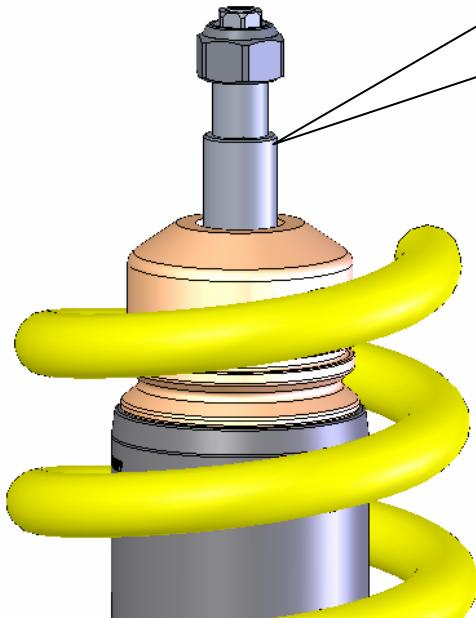
Das Original Domlager aufsetzen und mit der im Lieferumfang enthaltenen Mutter festschrauben.
