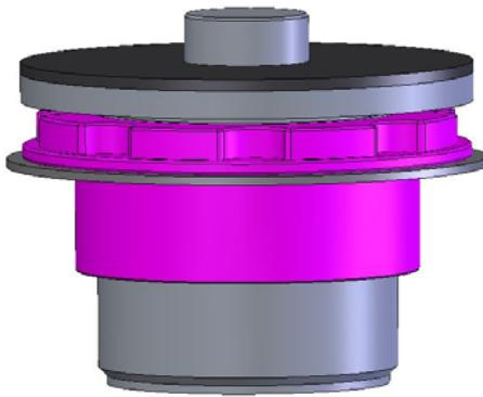
Das Anzugsdrehmoment der Kolbenstangenbefestigung beträgt 25 Nm. Die Montagehinweise zum Einbau des Dämpfers in das Fahrzeug, sowie die Anzugsdrehmomente der Dämpferbefestigung, entnehmen Sie bitte den Unterlagen des Fahrzeugherstellers.
