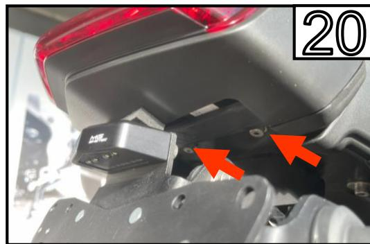
Führen Sie das Rücklicht auf seine vorherige Position und verbinden diesen mit den M5 Schraubenset auf der Grundplatte.
