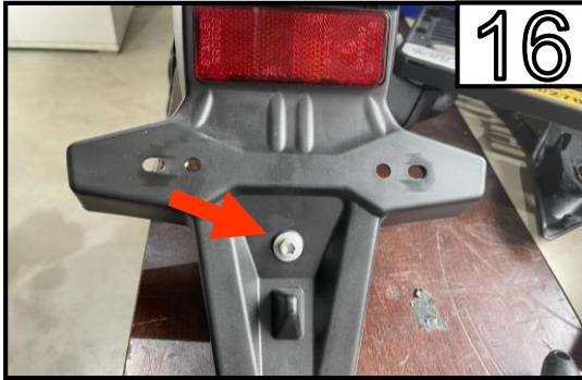
Entfernen Sie die Schraube und die Abdeckung.
