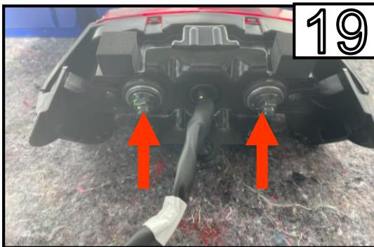
Montieren Sie das Rücklicht auf den Bügel mit den originalen Muttern.
