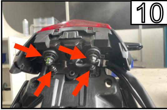
Entfernen Sie die 2 Schrauben und die 2 Schrauben an der Unterseite um das Rücklicht zu entfernen.
