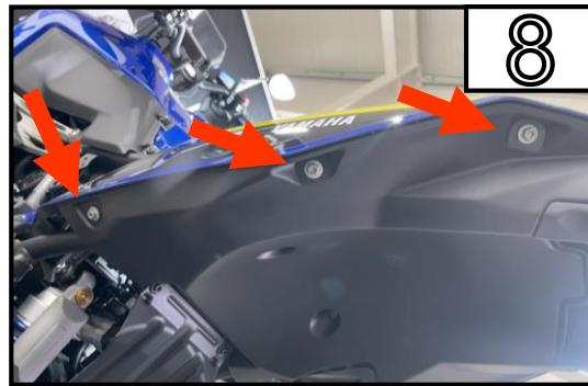
Entfernen Sie die 3 Schrauben beidseitig und entfernen Sie die Verkleidung.
