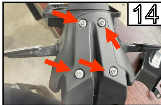
Entfernen Sie die 4 Schrauben.
