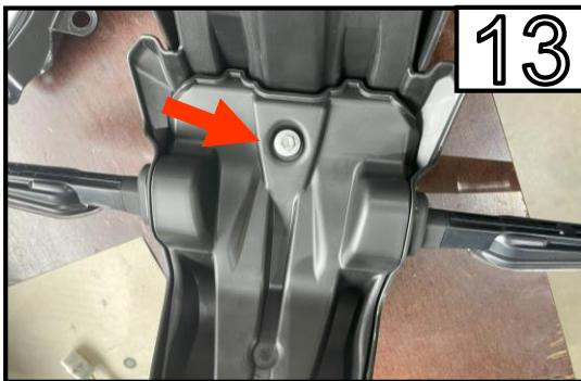
Entfernen Sie die Schraube.
