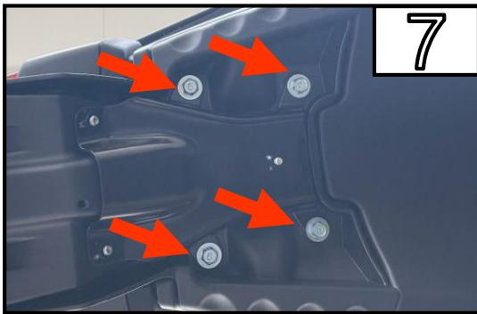
Entfernen Sie die 4 Schrauben an der Unterseite.
