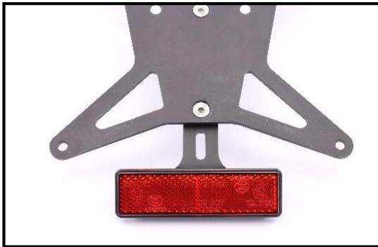
Montieren Sie den beigelegten Reflektor am MG
