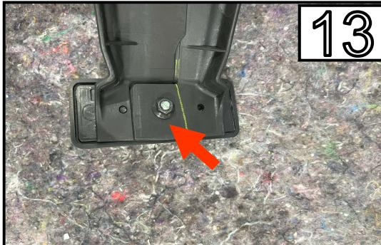
Entfernen Sie die Mutter und trennen Sie den originalen Kennzeichenträger.
