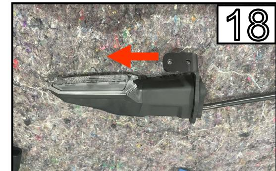
Montieren Sie den Blinker in der Halterung
