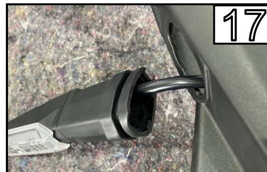
Entfernen Sie den Blinker aus der Halterung.
