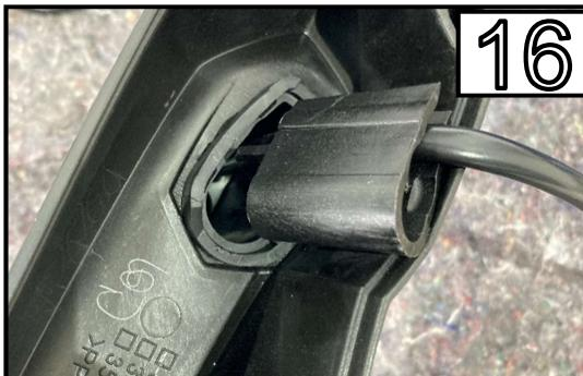
Entfernen Sie das Kunststoffstück aus dem Blinker.
