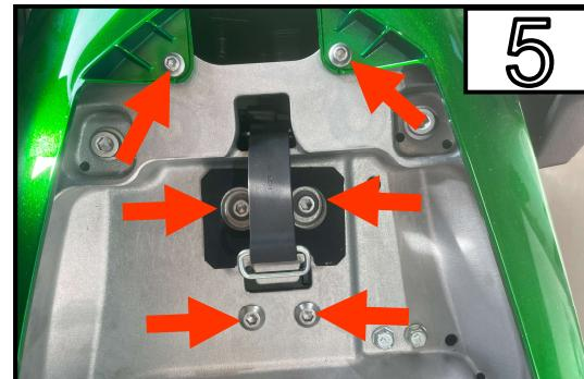
Entfernen Sie die 6 Schrauben.
