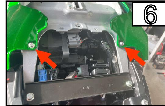
Entfernen Sie die 2 Schrauben und die Verkleidung.
