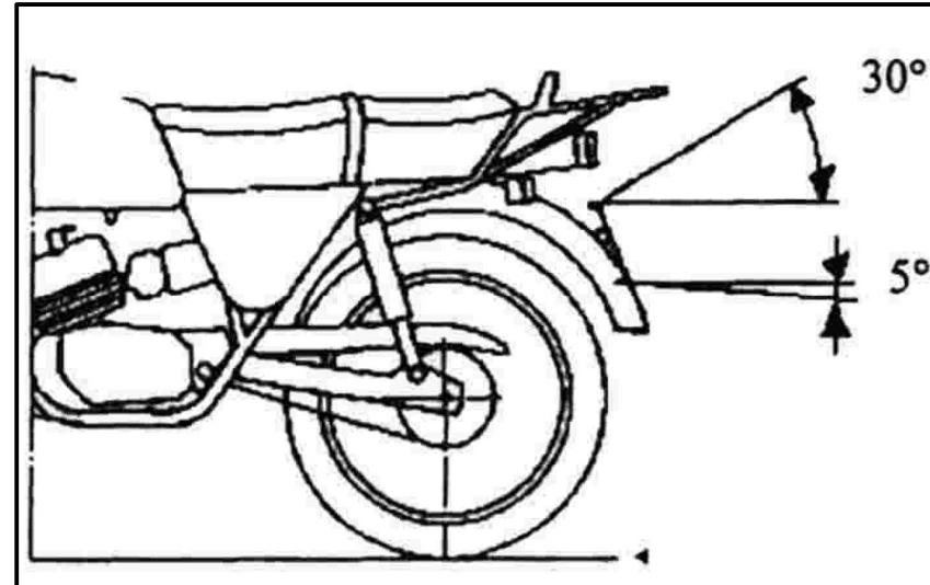
Richten Sie nun, den Kennzeichenträger so am Fahrzeug aus (Schraube A), dass er symmetrisch am Fahrzeugs sitzt und vom Winkel den gesetzlichen Anforderungen von  $30^\circ$  entspricht (siehe oberes Bild).
