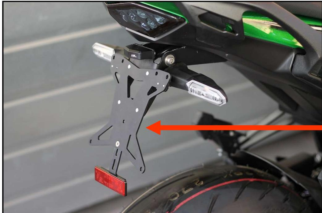
DE: ACHTUNG: Montieren Sie nur Ihr Nummernschild – verwenden Sie keine zusätzliche Stahl- oder Aluminium-Trägerplatte – dies kann zu Bruchschäden an der Halterung führen!!
