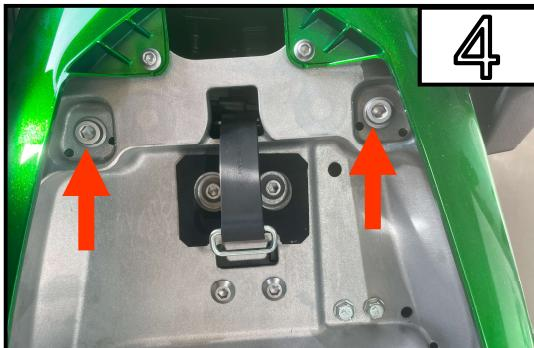
Entfernen Sie die 2 Schrauben und den Bügel auf der L & R.
