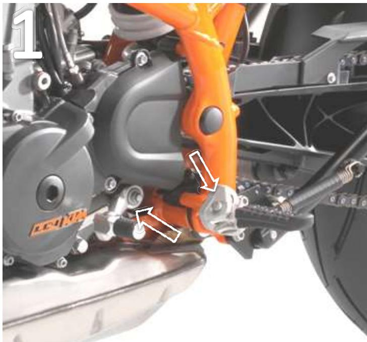
Originale Fußrastenanlage mit Schalthebel und Schaltstange auf der linke Seite demontieren.
