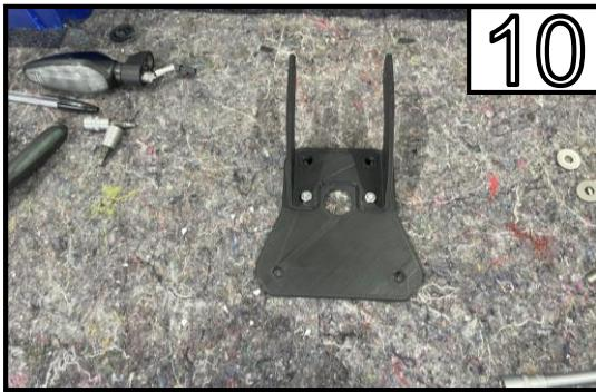
Verschrauben Sie den Bike Adapter mit der Grundplatte.
