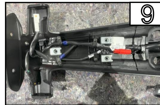
Entfernen Sie den Kabelbaum aus dem Kennzeichenträger.
