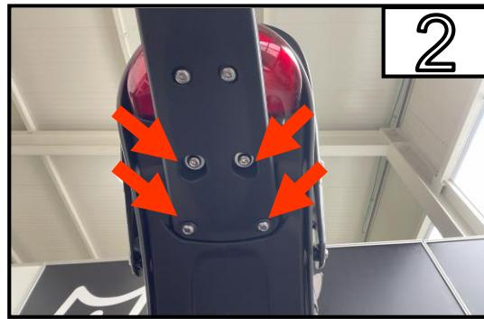
Entfernen Sie die 4 Schrauben.
