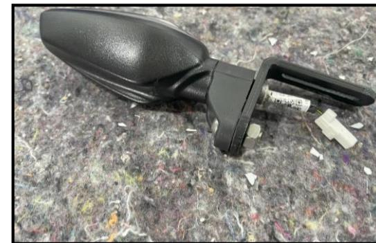
Verschrauben Sie den Blinker mit den Blinkerhalter.
