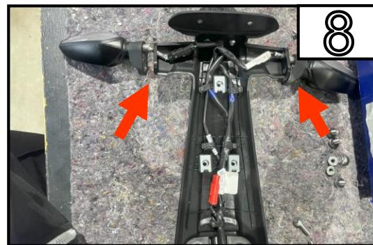
Trennen Sie die Kabel der Blinker und entfernen Sie diese aus dem originalen Kennzeichenträger.
