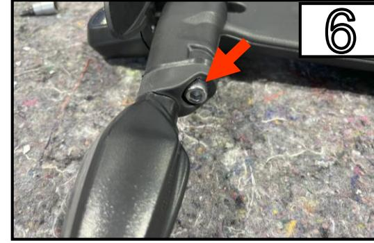
Entfernen Sie die 2 Schrauben L & R.
