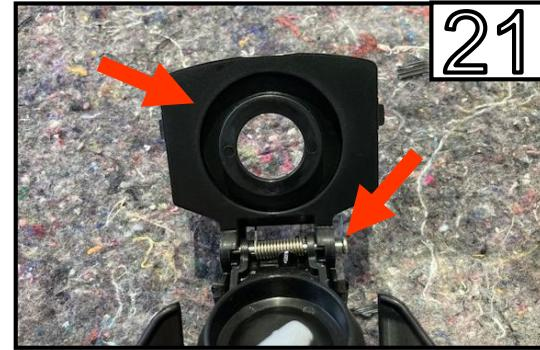
Stift, Feder und Klappe von der originalen Abdeckung entfernen.
