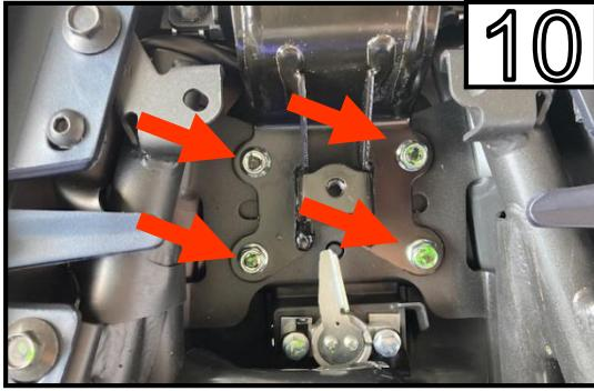
Entfernen Sie die 4 Schrauben und vorsichtig den Kennzeichenträger.
