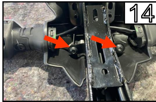
Entfernen Sie die 2 Schrauben und den Bügel.
