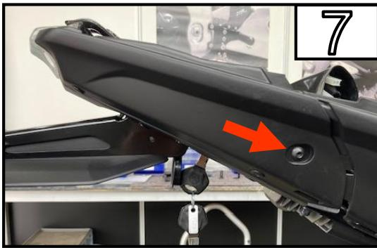
Entfernen Sie die Schraube und seitliche Verkleidung.
