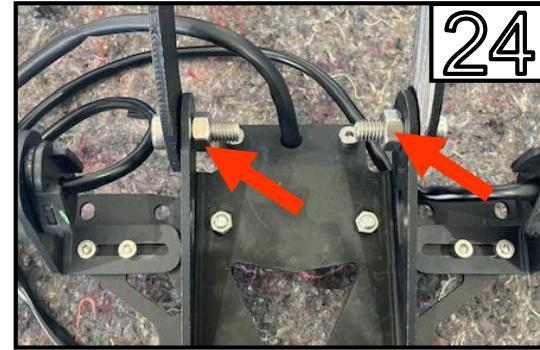
Verbinden Sie den Adapter mit der Kennzeichenplatte mit den mitgelieferten M8 Schraubenset.
