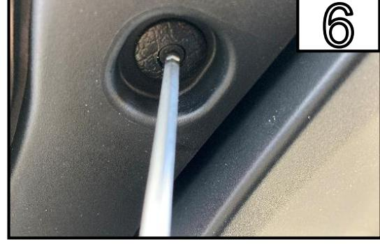
Entfernen Sie die 2 Schraube und die seitliche Verkleidung.
