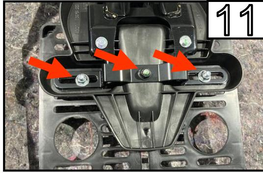
Entfernen Sie die 3 Schrauben und den Bügel.
