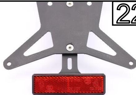
Montieren Sie den beigelegten Reflektor am MG Biketec Kennzeichenträger.
