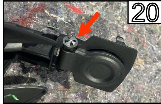
Entfernen Sie bei der originalen Kennzeichenabdeckung den Sicherungsring.
