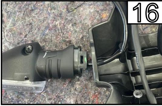
Entfernen Sie den Blinker aus dem
