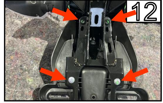
Entfernen Sie die 4 Schrauben.
