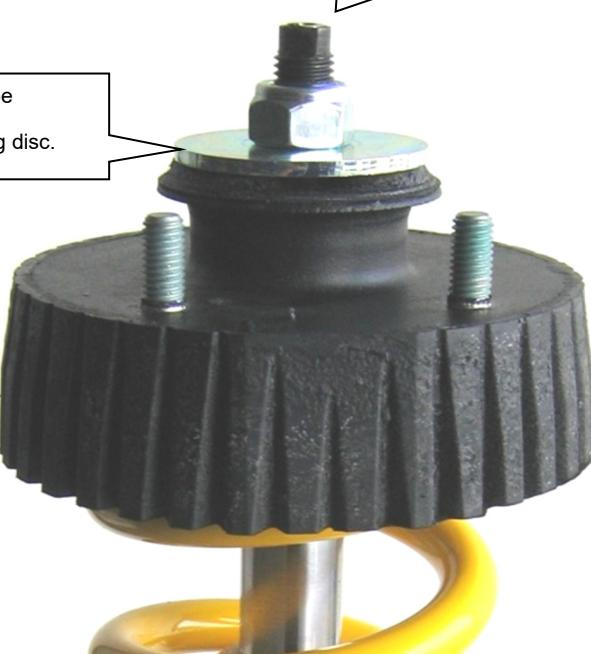
Nach erfolgtem Einbau des Fahrwerkes ist die Freigängigkeit der Bereifung zum VA-Federbein zu überprüfen. Das Mindestabstandsmaß darf an der engsten Stelle **5 mm** nicht unterschreiten und ist gegebenenfalls mittels handelsüblicher, geprüfter Distanzscheiben wieder herzustellen.
