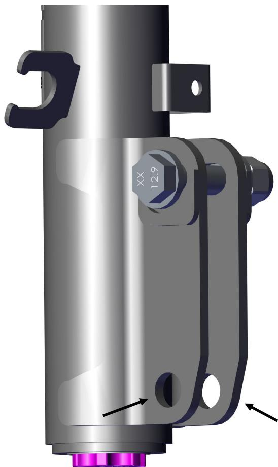
Bei Fahrzeuge mit einer unteren M12 Schraub, muss die mitgelieferte Distanzhülse in das Federbein eingepresst werden.
