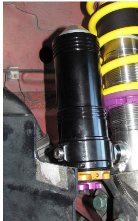
Nach erfolgtem Einbau des Fahrwerkes ist die Freigängigkeit der Bereifung zum VA-Federbein zu überprü-
