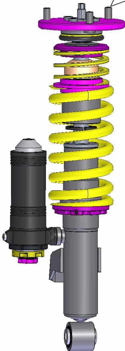
Das Federbein muss so positioniert werden, dass der Ausgleichsbehälter, wie im Bild zu sehen, oberhalb der Antriebswelle liegt.
