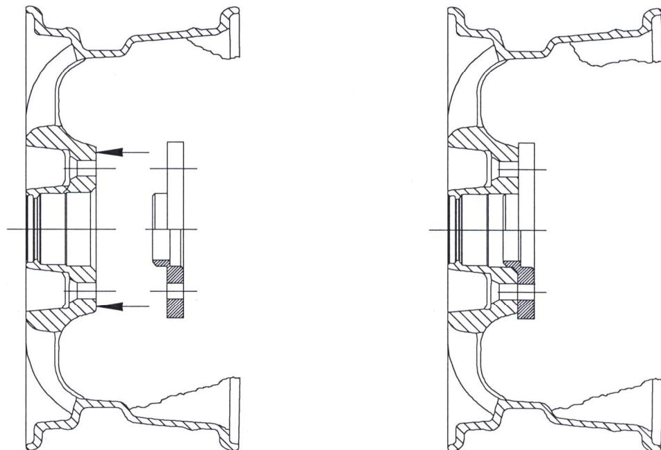
Anschliessend ist die Distanzscheibe auf die Innenseite des Rades aufzustecken.
