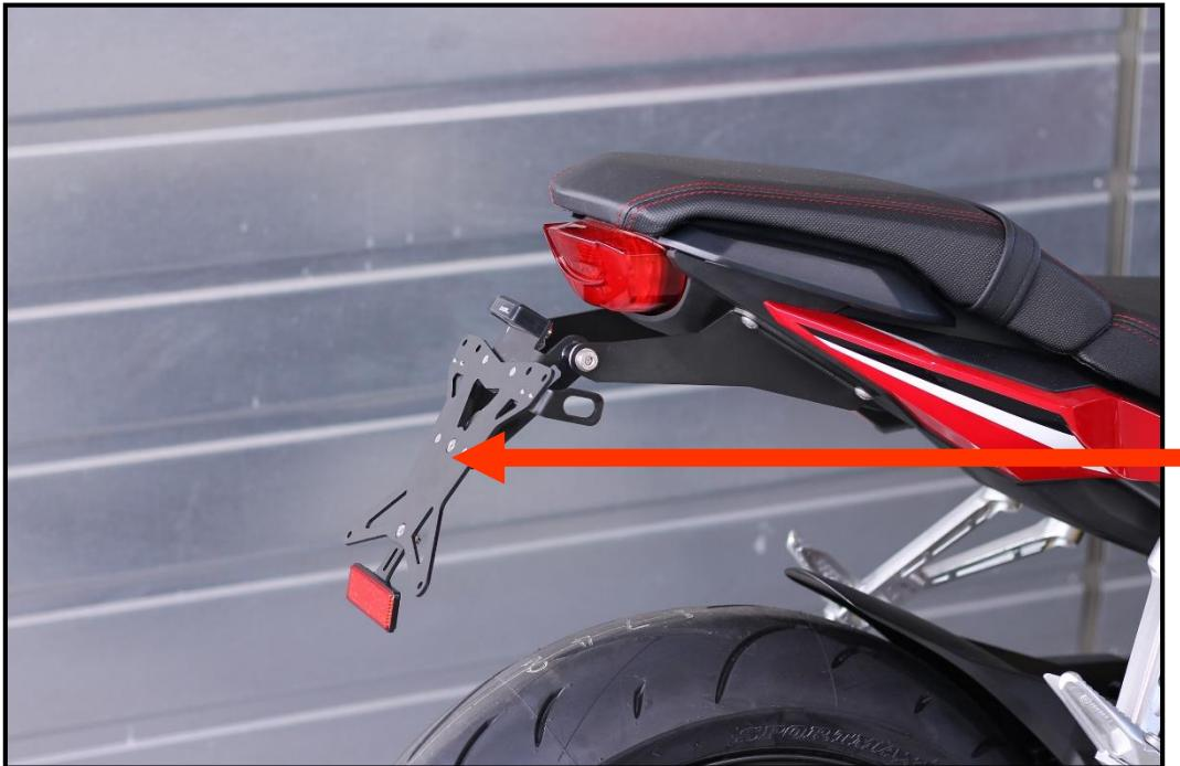
**DE: ACHTUNG:** Montieren Sie nur Ihr Nummerntafel – verwenden Sie keine zusätzliche Stahl- oder Aluminium-Trägerplatte – dies kann zu Bruchschäden an der Halterung führen!!
