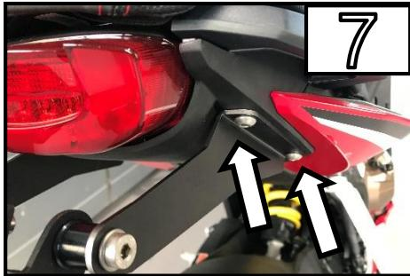
Montieren Sie den MG Biketec Kennzeichenträger am Motorrad /
