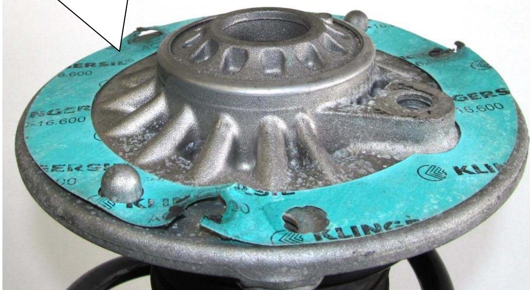
SD Kit auf das Stützlager aufsetzen.
