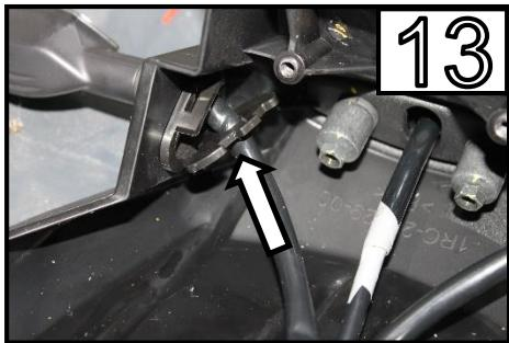
Entnehmen sie die Sicherungsplatte aus dem Blinker/
