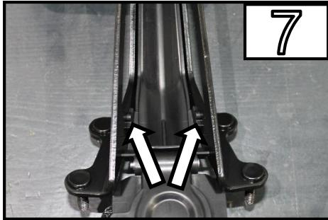
Lösen Sie die beiden Klips /
