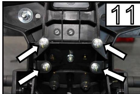
Lösen Sie alle 4 Schrauben /
