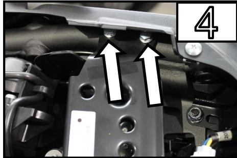
Lösen sie die Beiden Schrauben /
