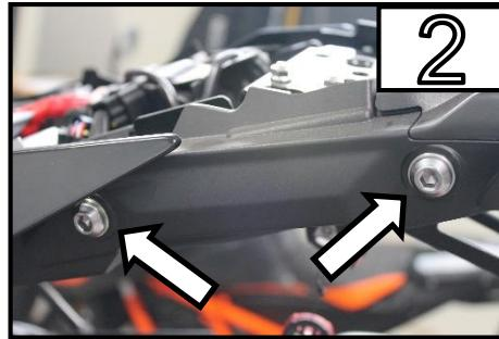
Lösen Sie die Beiden Schrauben /
