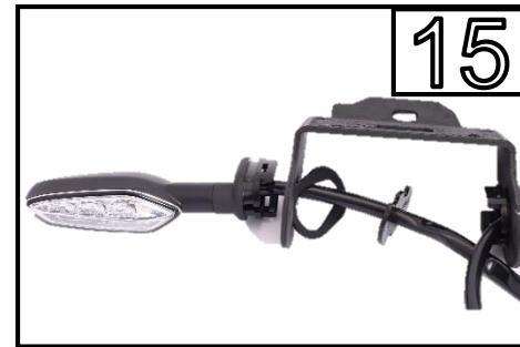
Montieren Sie die Blinker auf dem MG Biketec Kennzeichenträger /
