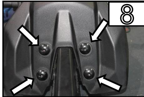
Lösen Sie alle 4 Schrauben /
