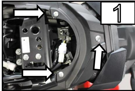
Entfernen Sie zuerst die Sitzbank, danach lösen Sie alle 3 Schrauben /
