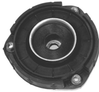
Original Domlager aufsetzen und mit der im Lieferumfang enthaltenen Mutter verschrauben. Das Anzugsdrehmoment der Kolbenstangenbefestigung beträgt 50 Nm. Die Montagehinweise zum Einbau des Federbeines in das Fahrzeug, sowie die Anzugsdrehmomente der Federbeinbefestigung, entnehmen Sie bitte den Unterlagen des Fahrzeugherstellers.
