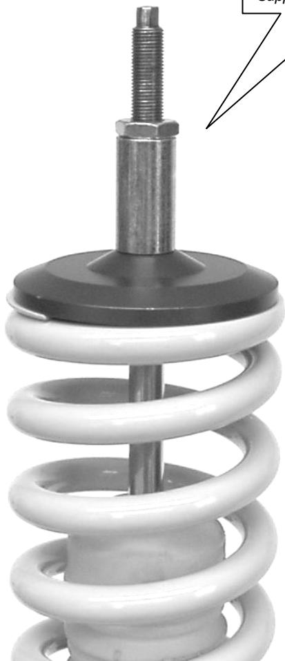
Das Original Stützlagergummi und die Zentrierscheibe, wie im Bild dargestellt, aufsetzen. Federbein mit den Originalteilen, wie beim Serienfahrwerk, mit der Karosserie verschrauben. Das Anzugsdrehmoment der Kolbenstangenbefestigung beträgt 25 Nm. Die Montagehinweise zum Einbau des Federbeins in das Fahrzeug, sowie die Anzugsdrehmomente der Federbeinbefestigung, entnehmen Sie bitte den Unterlagen des Fahrzeugherstellers.
