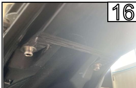
Montieren Sie den unteren Bike Adapter 2 mit dem mitgelieferten M6 Schraubenset.
