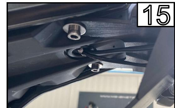
Blinker Kabel durch den originalen Ausschnitt führen.
