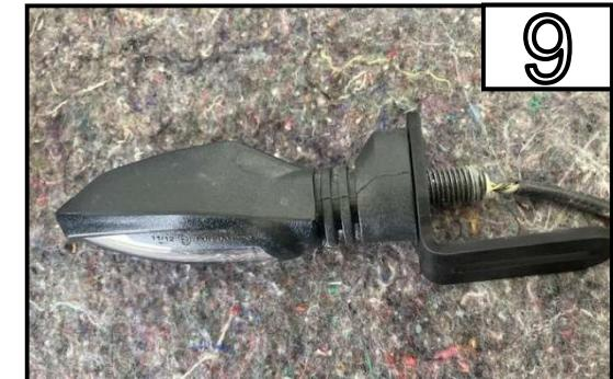
Montieren Sie beide Blinker am Halter und befestigen diesen mit der originalen Mutter.
