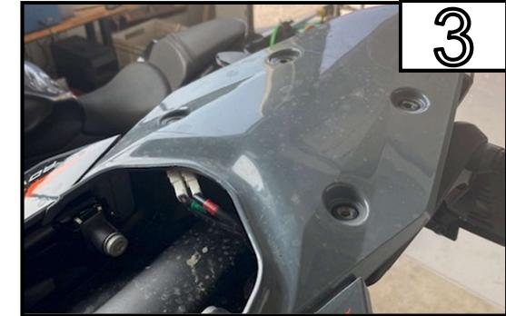
Entriegeln Sie die Sitzbank mit dem Fahrzeugschlüssel und entfernen Sie diese.
