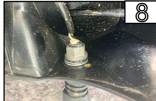
Entfernen Sie die Mutter für die Blinker (L&R) und ziehen Sie dann die Blinker aus der Halterung heraus.
