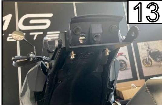
Montieren Sie den oberen Bike Adapter 1 mit dem mitgelieferten M6 Schraubenset.
