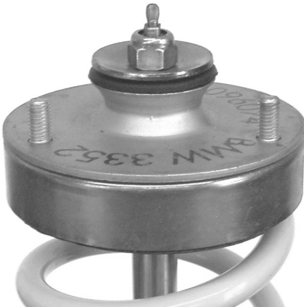
Die serienmäßige Zusatzfeder (Elastomer) incl. Schutzrohr muss weiterverwendet werden. Diese muss in einwandfreiem Zustand sein, gegebenenfalls durch Neuteil ersetzen.
