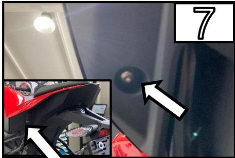
Entfernen Sie die nächste gezeigte Schraube. Im kleinen Bild wird die Position der Schraube gezeigt. Auf beiden Seiten ausführen / Remove the next marked bolt. The location of the bolt can be seen in the small picture. Remove on both sides.
