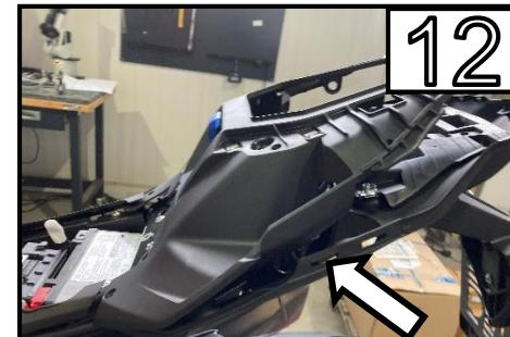
Entfernen Sie nun den im Bild gezeigten Kunststoffteil. **Achtung!!** Wieder vorsichtig abnehmen – An der gezeigten Stelle befinden sich die Stecker für die Blinker für Schritt 13 / Now remove the plastic panel shown in the picture. **Attention!!** Remove carefully - The connectors for the indicators (step 13) are located at the point shown
