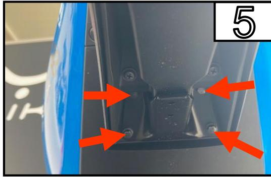
Entfernen Sie die 4 Befestigungsschrauben des Halters.
