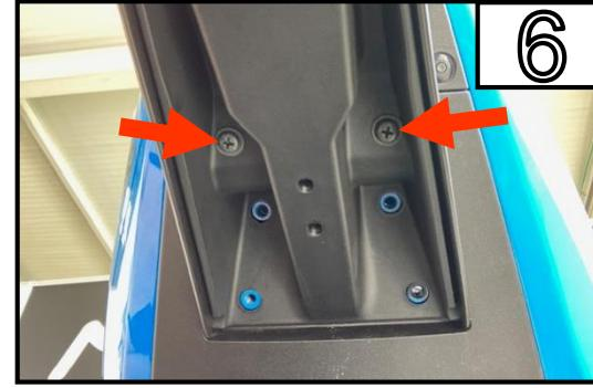
Entfernen Sie die übrigen 2 Schrauben und entfernen Sie vorsichtig die Kennzeichenhalterung.
