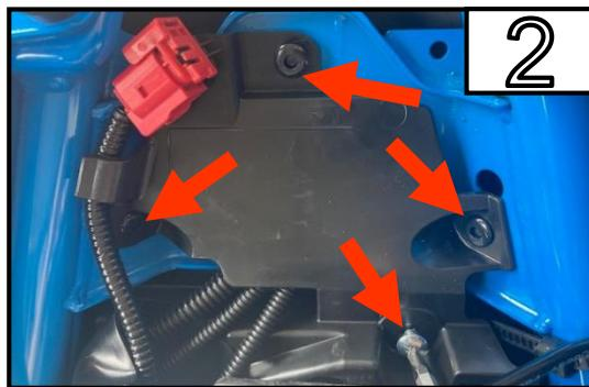
Entfernen Sie die 3 Kunststoffclips und die Schraube.
