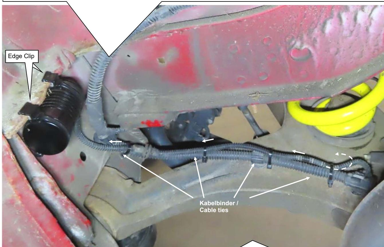
Originale Dämpfersteuerungsleitung mit Kabelbindern befestigen.
