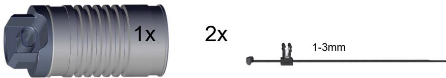
Originale Dämpfersteuerungsleitung in die mitgelieferte Stillelung einstecken. Auf die korrekte Verriegelung des Steckers achten!
