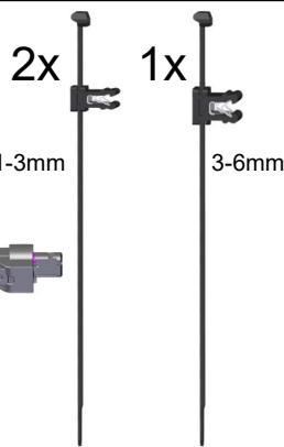
Verlängerungsleitung in die Stilllegung sowie in den originalen Kabelbaum einstecken. Auf die korrekte Verriegelung des Steckers achten! Stilllegung und Leitung mit Edge Clips / Kabelbindern an der Karosseriekante befestigen.
