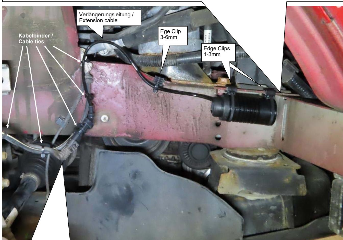
Originale Dämpfersteuerungsleitung mit Kabelbindern befestigen.
