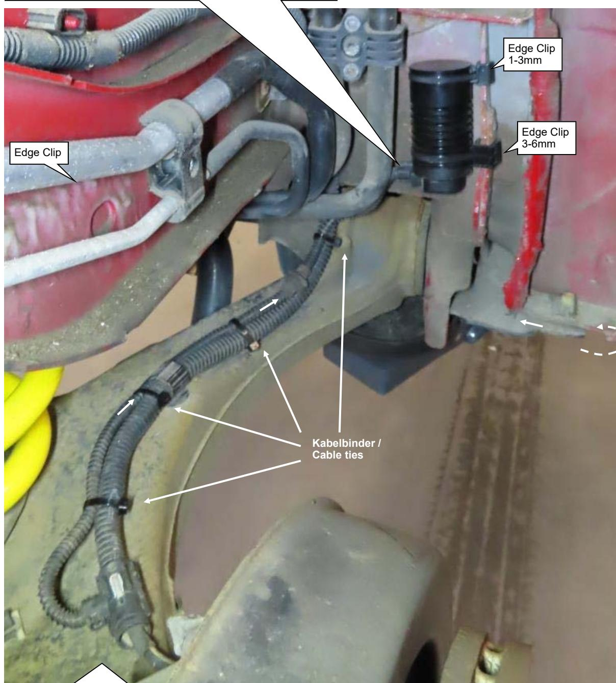
Originale Dämpfersteuerungsleitung mit Kabelbindern befestigen.
