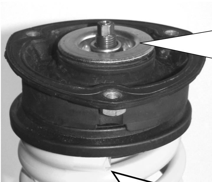
Das originale Stützlagerring aufsetzen und mit der im Lieferumfang enthaltenen Mutter festschrauben. Das Anzugsdrehmoment der Kolbenstangenbefestigung beträgt 50 Nm. Die Montagehinweise zum Einbau des Federbeines in das Fahrzeug, sowie die Anzugsdrehmomente der Federbeinbefestigung, entnehmen Sie bitte den Unterlagen des Fahrzeugherstellers.
