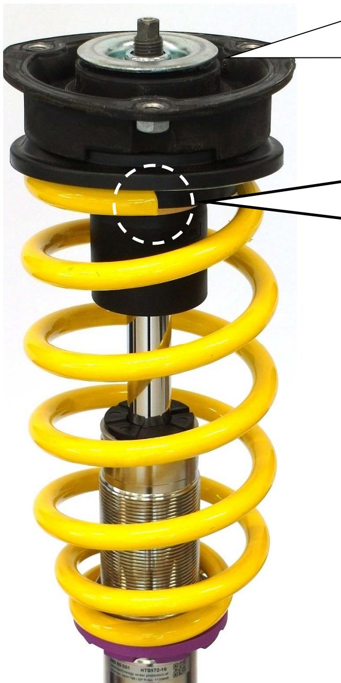
Das originale Stützlager aufsetzen und mit der im Lieferumfang enthaltenen Mutter festschrauben. Das Anzugsdrehmoment der Kolbenstangenbefestigung beträgt 50 Nm. Die Montagehinweise zum Einbau des Federbeines in das Fahrzeug, sowie die Anzugsdrehmomente der Federbeinbefestigung, entnehmen Sie bitte den Unterlagen des Fahrzeugherstellers.
