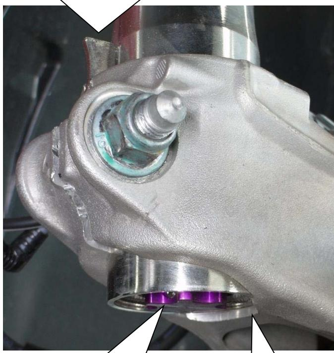
Nach erfolgtem Einbau des Fahrwerkes ist die Freigängigkeit der Bereifung zum VA-Federbein zu überprüfen. Das Mindestabstandsmaß darf an der engsten Stelle **5 mm** nicht unterschreiten und ist gegebenenfalls mittels Distanzscheiben wieder herzustellen.
