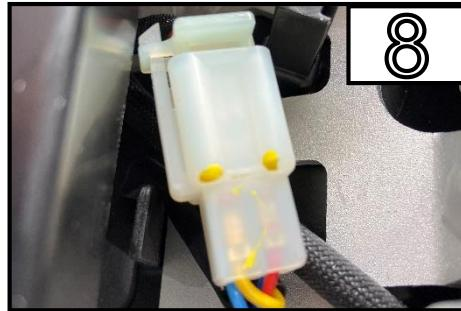
Trennen Sie das Hauptkabel für den Kennzeichenträger /
