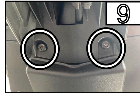
Entfernen Sie die beiden Schrauben.
