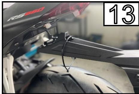
Entfernen sie den Kennzeichenträger vom Motorrad /
