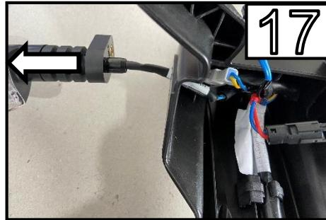
Entfernen Sie die Blinker vom Kennzeichenträger /
