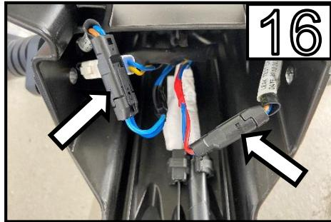
Trennen Sie die Beiden Kabel für die Blinker /
