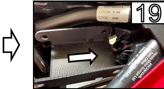
Schieben Sie die Abdeckplatte (Bauteil 10) von links nach rechts in die Plastikführung ein. /
