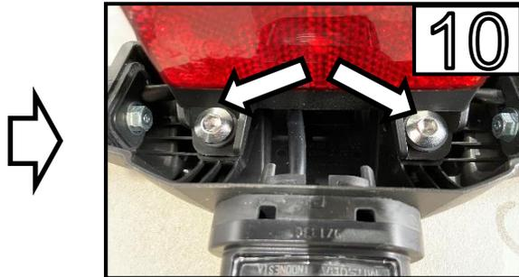
Entfernen Sie die beiden Schrauben /
