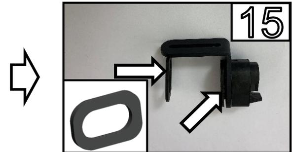
Geben Sie den Blinker Adapter Ring (Bauteil 12) auf die Innenseite der Gummihalterung /
