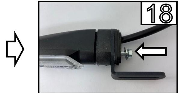
Befestigen Sie den Blinker mit der originalen Schraube /
