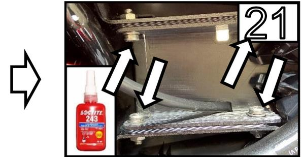
Befestigen Sie den Kennzeichenträger mit den mitgelieferten Schrauben (Bauteil 13). Verwenden Sie die originalen Muttern und eine Schraubensicherung /
