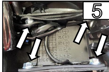
Entfernen Sie alle 4 Schrauben des
