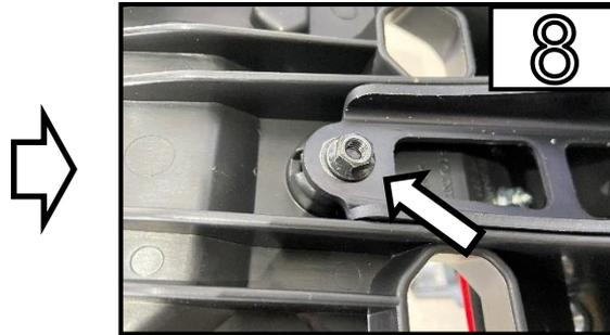
Entfernen Sie die Schraube /
