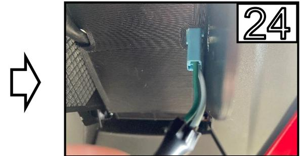
Führen Sie die Kabel durch die Öffnung /
