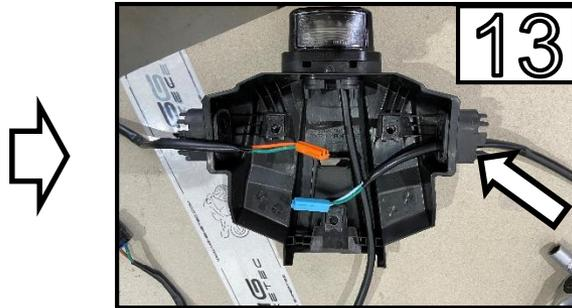
Ziehen Sie die Blinker heraus und entfernen Sie die Gummihalterungen/
