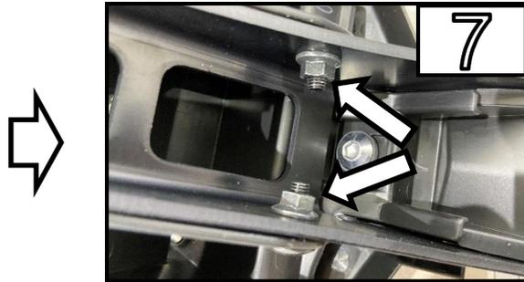
Entfernen Sie die beiden Schrauben /
