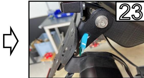
Führen Sie die Kabel durch die Öffnung durch /
