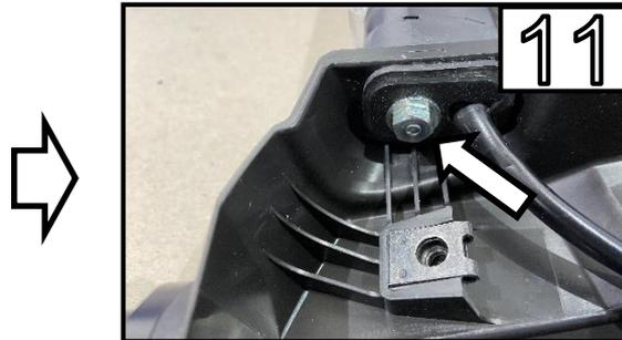
Entfernen Sie die Schraube des Blinkers /
