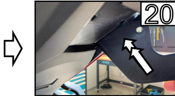
Führen Sie nun die beiden Bike Adapter (Bauteil 9) ins Motorrad ein. /
