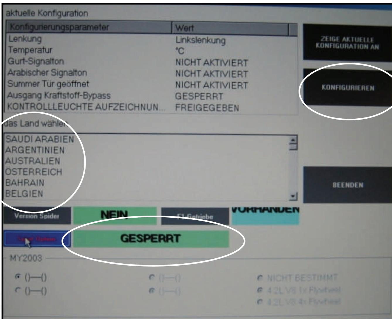
Nach Abschluss der Konfiguration ist die Elektronische Dämpferregelung dauerhaft deaktiviert und im Display wird POWER angezeigt.
