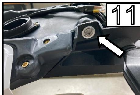
Entfernen Sie auf beiden Seiten die im Bild gezeigte Schraube und nehmen Sie den Kennzeichenträger vom Motorrad ab /
