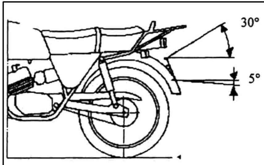
Nach Abschluss der elektrischen Installation, montieren Sie den vormontierten Kennzeichenträger an die originalen Montagepunkte.
