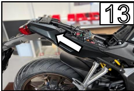
Ziehen sie die Seitenverkleidung etwas nach hinten bis sie sich löst und dann ziehen Sie die Verkleidung vorsichtig ab /
