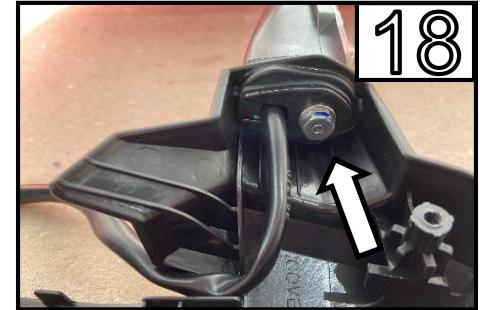
Entfernen Sie die Schraube des Blinkers /
