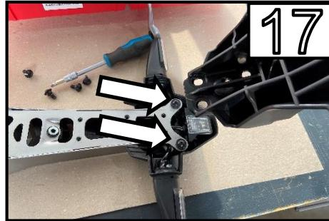
Entfernen Sie den Kennzeichenträger und die beiden markierten Schrauben /
