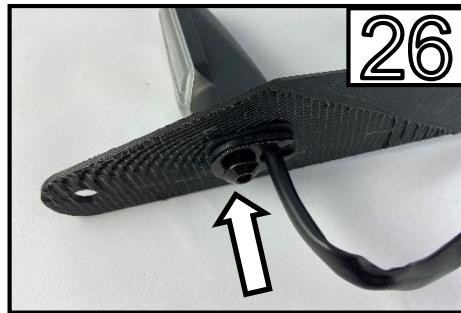
Verschrauben Sie den Blinker mit der originalen Schraube /
