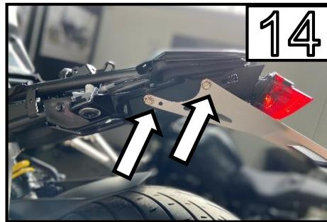
Entfernen Sie die die Schrauben des Kennzeichenträger /
