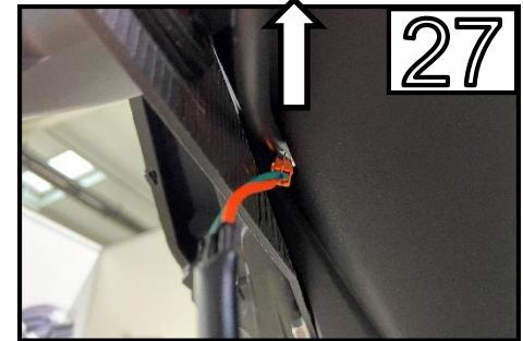
Führen Sie die Originalen Blinker Kabel wieder ins Motorrad hinein /
