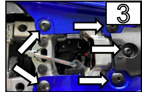
Entfernen Sie alle 5 markierten Schrauben /
