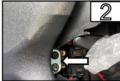
Entfernen Sie die beiden Schrauben für den Fahrersitz /
