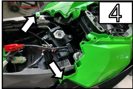
Entfernen Sie die beiden Kunststoffclips indem Sie den Stift in der Mitte hineindrücken. Entfernen Sie die schwarze Seitenverkleidung.
