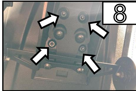
Entfernen Sie die 4 Schrauben und nehmen Sie den Kennzeichenträger ab /
