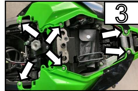
Entfernen Sie alle 6 markierten Schrauben /
