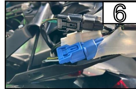
Trennen Sie die beiden Stecker der Blinker und den der Kennzeichenbeleuchtung /
