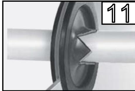
Führen Sie die Kabel durch den mitgelieferten Kunststoff durch. /
