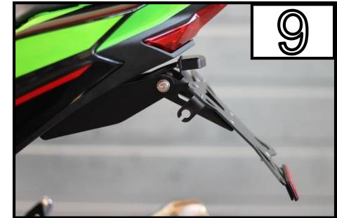
Montieren Sie den MG Biketec Kennzeichenträger in umgekehrten Reihenfolge am Motorrad (Verkabelung vorletzte Seite) /
