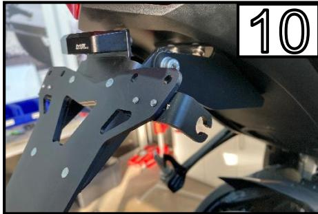
Montieren sie die Universalblinker am Kennzeichenträger. Bei M8 Blinker setzen sie die beigelegte Hülse ein. /
