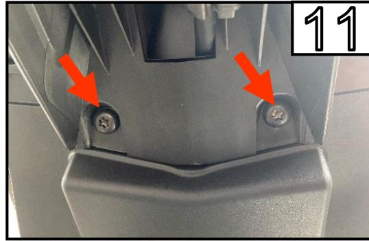
Entfernen Sie die beiden Schrauben. Mutter auf der Gegenseite muss eingehalten werden siehe Bild 12 und 13
