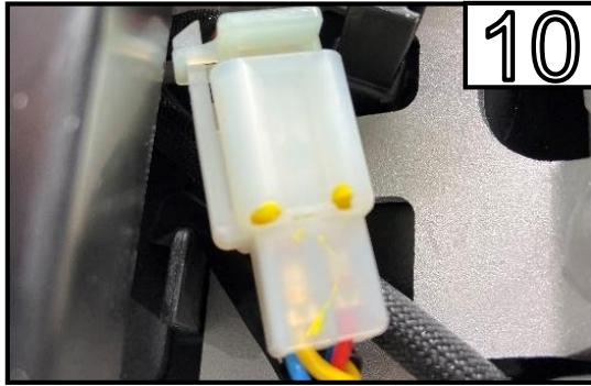
Trennen Sie das Hauptkabel für den Kennzeichenträger
