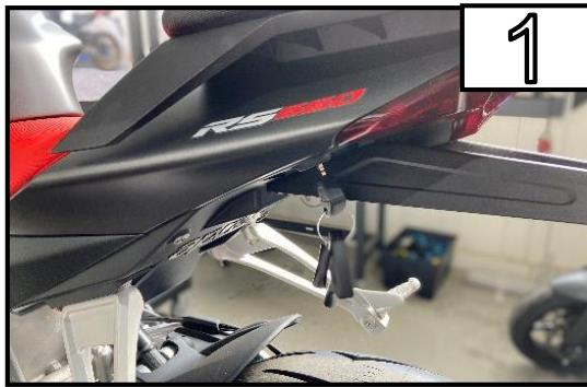
Entriegeln Sie die Sitzbank mit dem Fahrzeugschlüssel
