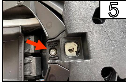
Entfernen Sie die Schraube
