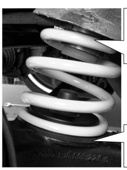
Die HA-Verstellung wird oben zwischen Feder und Karosserie montiert. Die serienmäßige Federunterlage entfällt. Zum Korrigieren (verdrehen des Gewinderings) der Fahrzeughöhe, ist die HA-Verstellung aus dem Fahrzeug zu demontieren.
