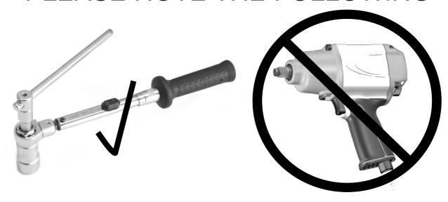
Nur Dämpferwerkzeug verwenden - Kein Schlagschrauber!
