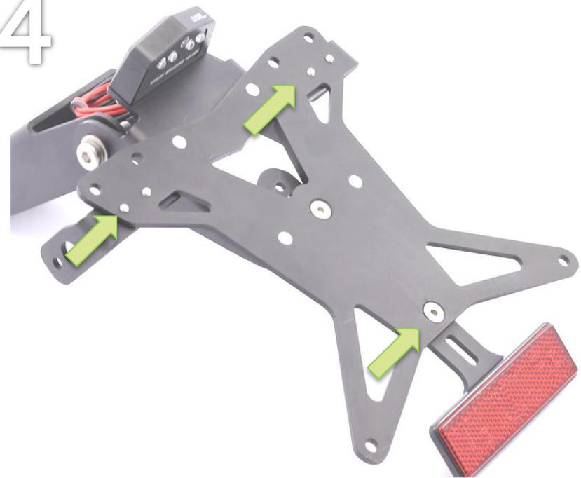
Montieren Sie den Reflektor sowie die Blinkerhalter mit den beiliegenden Schrauben.
