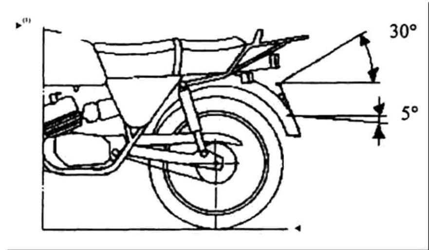
Nach Abschluss der elektrischen Installation, montieren Sie den vormontierten Kennzeichenträger an die originalen Montagepunkte.
