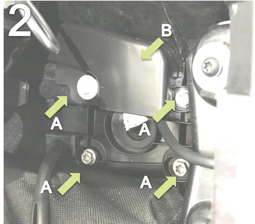
Lösen Sie die 4 Befestigungsschrauben (A) des originalen Kennzeichenträgers und entfernen Sie die Abdeckung (B).
