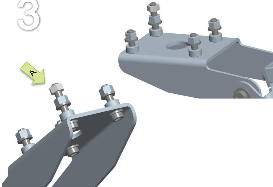
Montieren Sie die beige packen schrauben, Scheiben, Distanzbuchsen und Mutter am Fahrzeug wie in den oberen Bildern dargestellt. Beim rechten vorderen Befestigungspunkt muss die längere Schraube verwendet werden (A).
