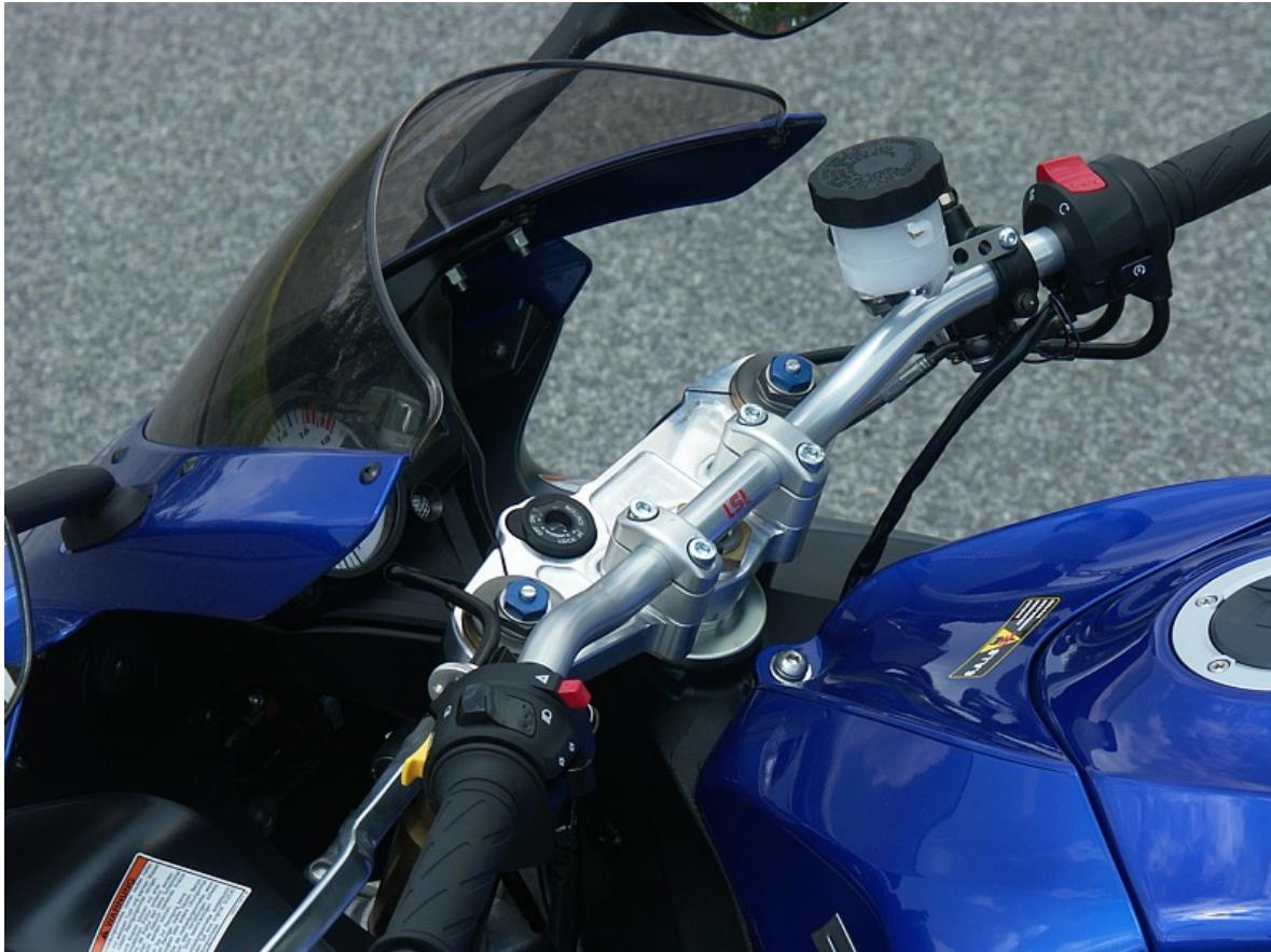
**i** Um Beschädigungen zu vermeiden und später die Züge neu verlegen zu können, muss als erstes der Tank hochgeklappt werden. Zur Sicherheit der elektrischen Systeme sollte während der Montage die Batterie am Minuspol abgeklemmt werden.
