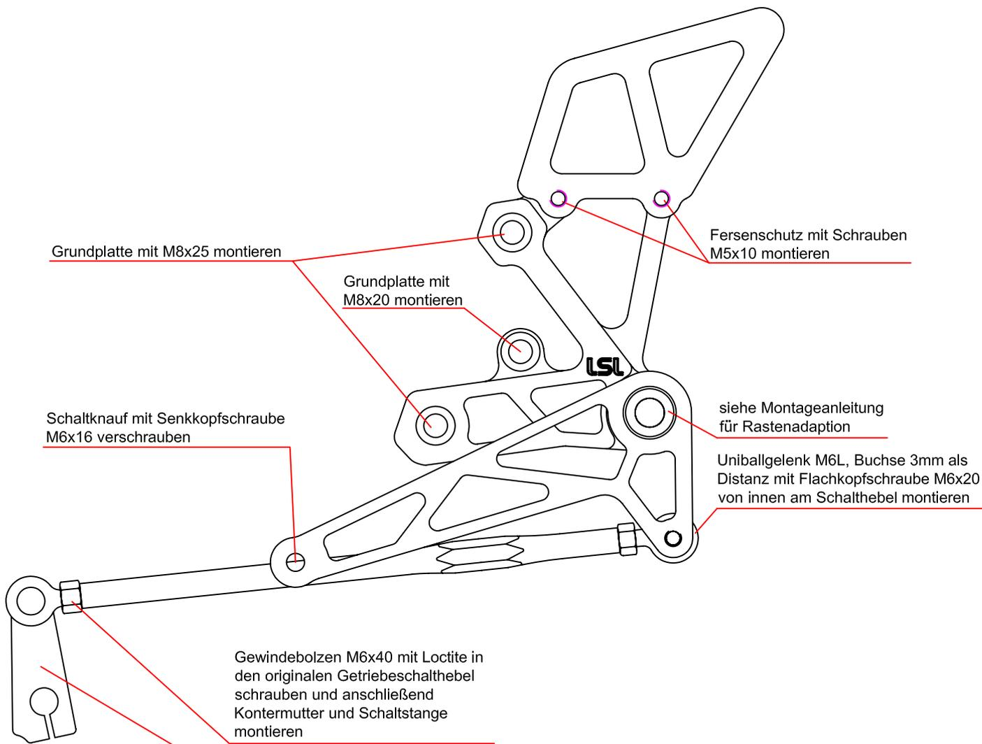
**Hinweis:** Für reverse Schaltlage den Getriebeschalthebel umdrehen, mit dem Ausleger nach unten!
