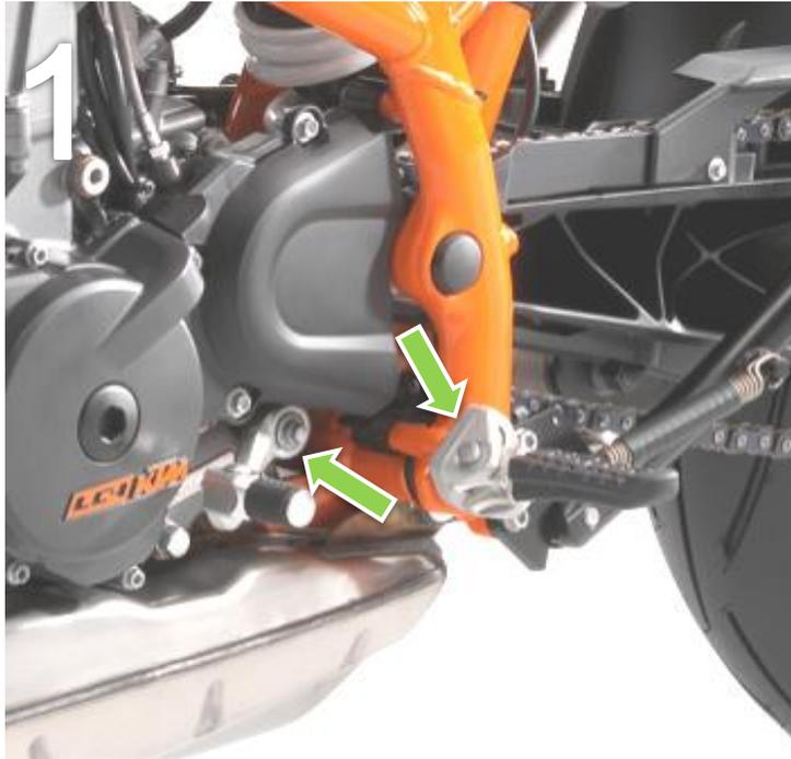
Originale Fußrastenanlage mit Schalthebel und Schaltstange auf der linken Seite demontieren.
