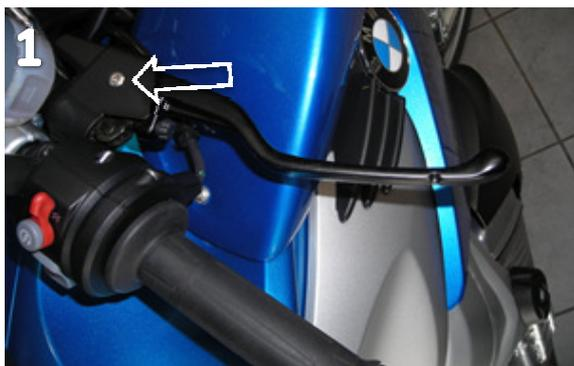
Entfernen Sie die originale Befestigungsschraube indem Sie die Mutter an der Unterseite abdrehen und anschließend die Schraube herausdrehen (Bild 1)
