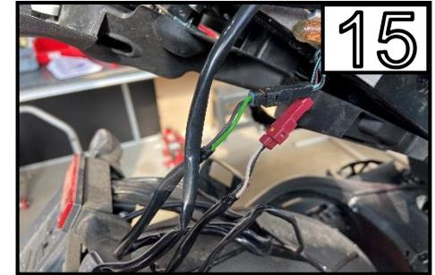
Trennen Sie die Stecker der Blinker und der Kennzeichenbeleuchtung /
