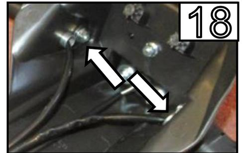
Entfernen Sie beide Schrauben und ziehen Sie den Blinkern heraus /
