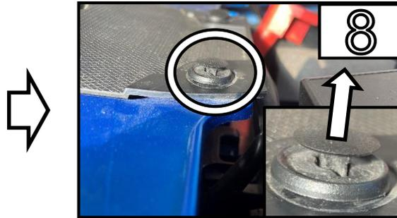
Um die Plastiknieten zum entfernen müssen Sie diese zuerst entriegeln indem Sie obere Kappe mit dem Stift nach oben ziehen /
