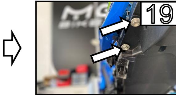
Montieren Sie den Kennzeichenträger Adapter am Motorrad /
