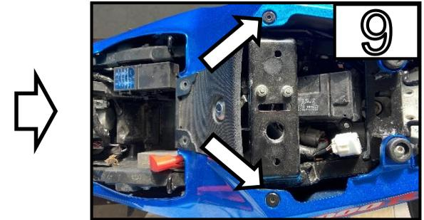
Entfernen Sie die beiden Schrauben /
