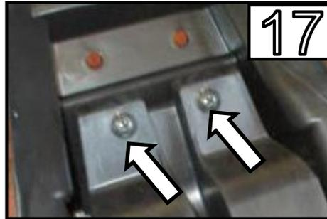
Entfernen Sie beide Schrauben /
