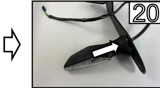
Führen Sie den Blinker in die vorgesehenen Bohrungen ein /
