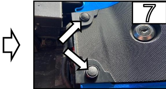
Entriegeln Sie die beiden Plastiknieten (siehe Bild 8) und entfernen Sie diese dann /
