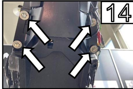
Entfernen Sie die 4 Schrauben des Kennzeichenträger und ziehen Sie ihn vorsichtig ab /
