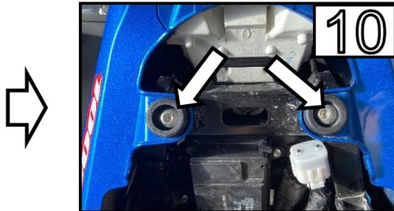
Entfernen Sie die beiden Schrauben /
