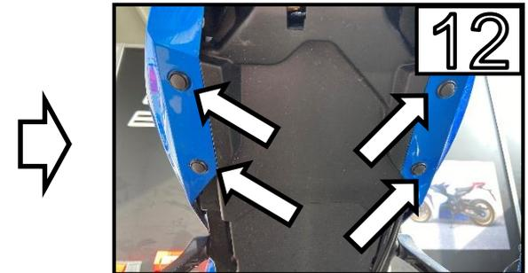
Entfernen Sie Alle 4 Plastiknieten wie in Bild 8 gezeigt /
