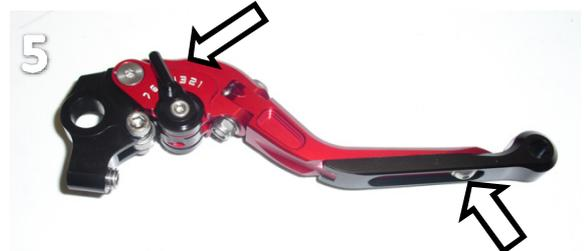
Der Hebel ist durch Drehen des Verstellhebels in 7 Positionen im Abstand einstellbar.
