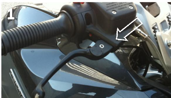
Entfernen Sie die originale Befestigungsschraube an der Unterseite abdrehen und anschließend die Schraube herausdrehen (Bild 1 oder 2)
