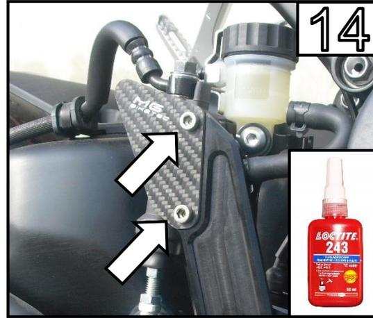
Befestigen Sie den Bremszylinder an der Trägerplatte B (Bauteil 5) und schrauben Sie den Carbon Fersenschutz (Bauteil 6) mit. Verwenden Sie hier Schraubensicherung (z.B.: Loctite 243). /
