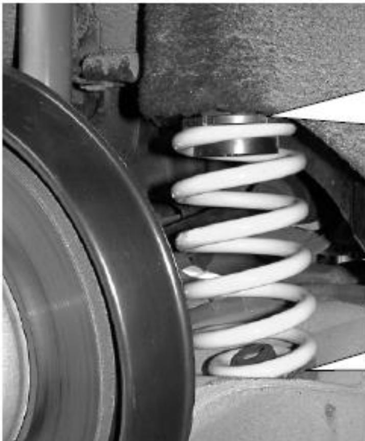
Die HA-Verstellung wird oben zwischen Feder und Karosserie montiert. Die serienmäßige Federunterlage entfällt. Zum Korrigieren (verdrehen des Gewinderring) der Fahrzeughöhe, ist die HA-Verstellung aus dem Fahrzeug zu demonstrieren.
