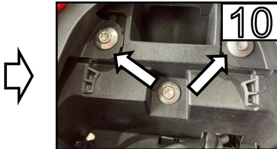
Entfernen Sie die beiden Schrauben /
