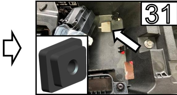
Geben Sie die beigelegten Kunststoffblöcke in die gezeigte Aussparung und verschrauben Sie den Kennzeichenträger von der Unterseite mit M6 Schrauben an. Alle 4 Schrauben ausrichten und festziehen /
