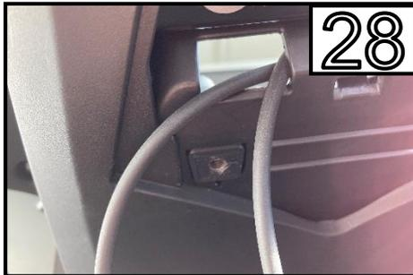
Geben Sie den Kennzeichenträger ans Motorrad und führen sie nun die Kabel durch die originale Aussparung /
