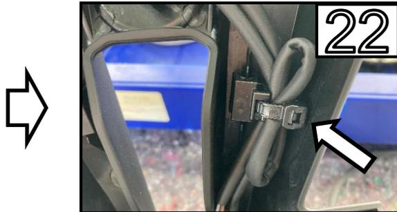
Öffnen Sie den im Bild gezeigten Kabelbinder. /
