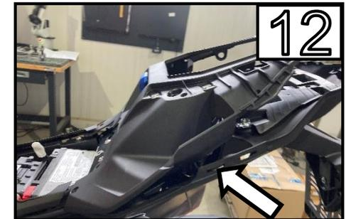
Entfernen Sie nun den im Bild gezeigten Kunststoffteil. **Achtung!!** Wieder vorsichtig abnehmen – An der gezeigten Stelle befinden sich die Stecker für die Blinker für Schritt 13 /
