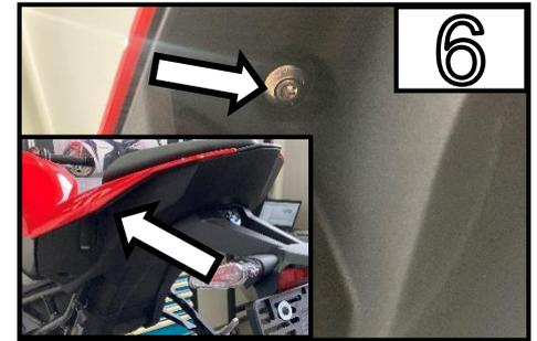
Entfernen Sie die gezeigte Schraube. Im kleinen Bild wird die Position der Schraube gezeigt. Auf beiden Seite ausführen /
