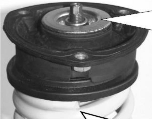
Das originale Stützlager aufsetzen und mit der im Lieferumfang enthaltenen Mutter festschrauben. Das Anzugsdrehmoment der Kolbenstangenbefestigung beträgt 50 Nm. Die Montagehinweise zum Einbau des Federbeines in das Fahrzeug, sowie die Anzugsdrehmomente der Federbeinbefestigung, entnehmen Sie bitte den Unterlagen des Fahrzeugherstellers.
