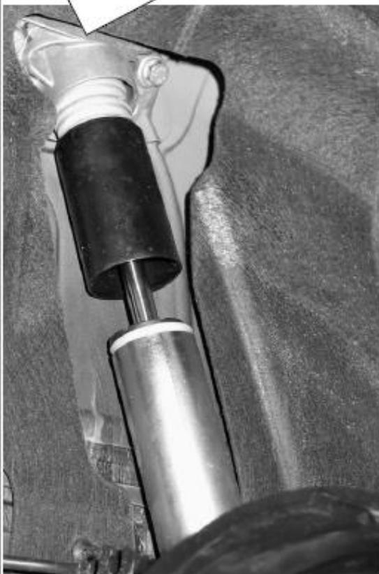
Mitgelieferte Höhenverstellung wird ohne Gummiunterlage zwischen Karosserie und Feder oben montiert.
