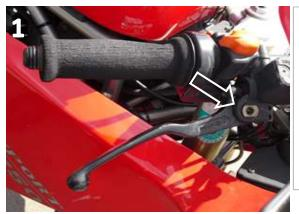
Entfernen Sie die originale Befestigungsschraube indem Sie die Mutter an der Unterseite abdrehen und anschließend die Schraube herausdrehen (Bild 1). Achten Sie darauf, die kleine Kunststoffstange, die zum hinteren- Bremslichtschalter führt, nicht zu verlieren.
