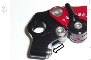
Nach der Einstellung ist die Einstellschraube mit Schraubensicherung (z.B. Loctite 270) zu sichern!!! (Bild 3)
