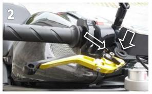
Bauen Sie den Hebel mit der Originalschraube und -mutter wieder an. Ziehen Sie die Mutter mit einem Drehmoment von 4 Nm fest (Bild 2).
