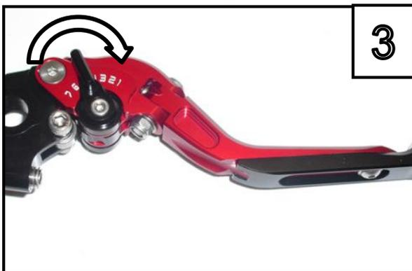
Der MG Biketec Hebel ist durch Drehen des Verstellers in 7 Positionen einstellbar.
