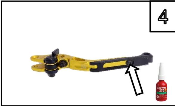
Achtung: Das schwarze Endstück des Hebels muss immer montiert sein. Falls es verstellt wird, verwenden Sie Schraubensicherung (z.B. Loctite 270) und fixieren die Schraube mit 3 Nm.
