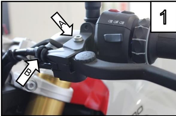
Entfernen Sie die originale Befestigungsschraube indem Sie die Mutter an der Unterseite abdrehen und anschließend die Schraube herausdrehen (A)
