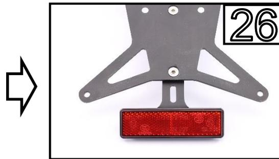
Montieren sie den beigelegten Reflektor am MG Biketec Kennzeichenträger /
