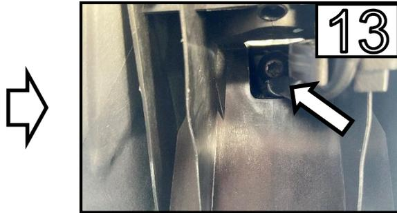
Entfernen Sie die letzte Schraube des Kennzeichenträgers /
