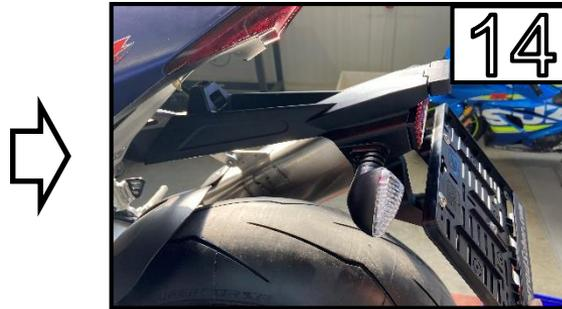
Entfernen sie den Kennzeichenträger vom Motorrad /
