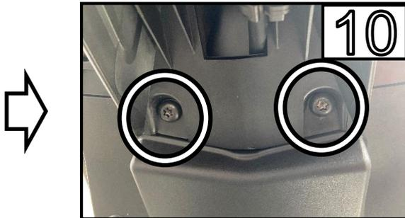
Entfernen Sie die beiden Schrauben.
